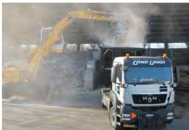
Camion semi-remorque pour le transport de déchets inertes. Capacité de chargement : 27 tonnes.
